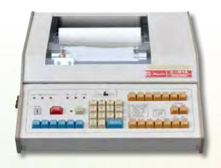
さらに、従来は別々の機器であったアナログレコーダーと解析装置をひとつのデータ処理装置とすることで、アナログ記録のクロマトグラムとデジタル記録の含有量や分析条件などが同時に一枚の記録紙に得られるようにし、データ整理が容易でかつ見やすく信頼性の高いレポートが迅速に得られるようになった。この結果、科学者はC-R1Aを使用することで、分析装置、計測装置の測定結果が瞬時に手に入るようになり、日本国内外の研究開発を加速する一助となった。
